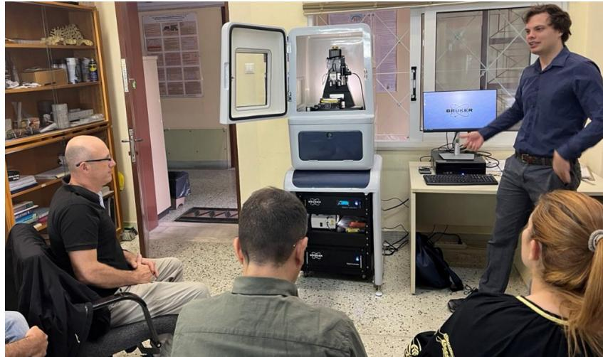
Ολοκληρώθηκε η διαδικασία εγκατάστασης **πειραματικής διάταξης νανοδιείσδυσης Hysitron TI Premier II** στη **Μονάδα Εμβιομηχανικής** του Διατομεακού Εργαστηρίου «**Εμβιομηχανικής και Βιοϊατρικής Φυσικής – ΕμβιοΦ**» της ΣΕΜΦΕ. Η διάταξη επιτρέπει τη μελέτη της απόκρισης και τον προσδιορισμό φυσικών και μηχανικών ιδιοτήτων
