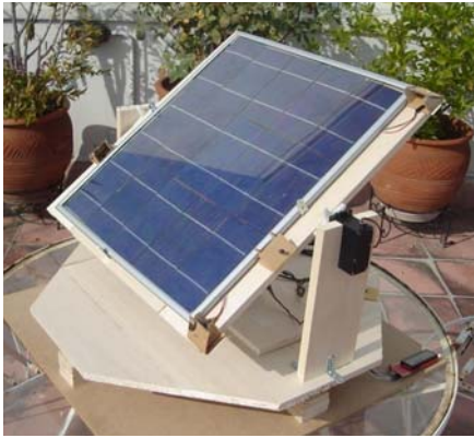
Σύστημα παρακολούθησης του ήλιου
